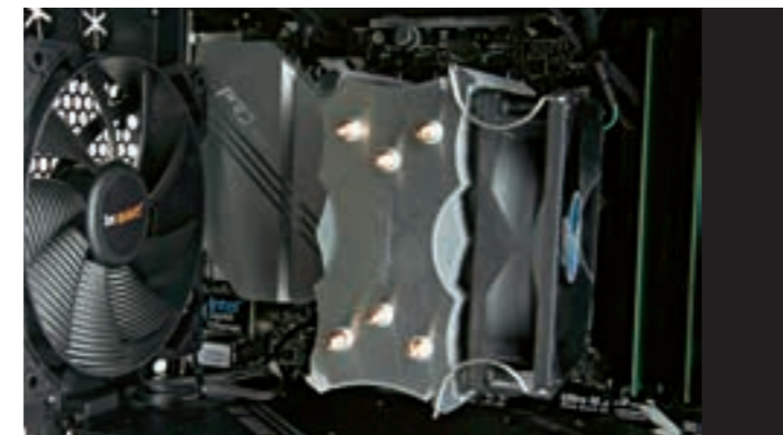
Die Intel-CPU Core i5-9400F sitzt unter einem größeren Kühlkörper samt Lüfter, der die Wärme des Prozessors abtransportiert.
