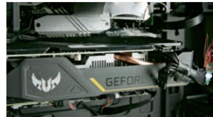
Den mit Nvidias neuem Grafikchip Geforce GTX 1650 Super und 4 Gigabyte Speicher bestückten Bildmacher hat Asus hergestellt.
