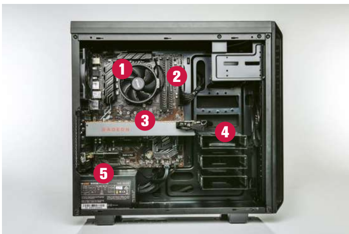
Schön aufgeräumt: der Prozessor Ryzen 5 3600 (unter dem Lüfter) 1, zwei Module mit je 8 Gigabyte Arbeitsspeicher 2, Grafikkarte Radeon RX 5700 3, 2,5-Zoll-SSD mit 477 Gigabyte Speicher 4, 600-Watt-Netzteil 5.
